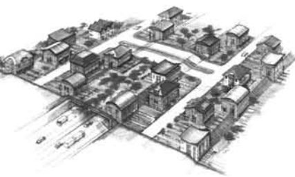
8.16 Licht en zwaar, twee onder één kap op de tunnel voor de A4 tSchiedam en gestapelde woningen tot 8 lagen hoog op de Donauufer-Autobahntunnel in Wenen.
