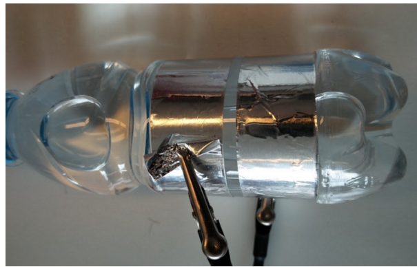
Figuur 5.4: Experimentele conductiviteitsensor opstelling met 25cl PET fles en aluminium ringen
