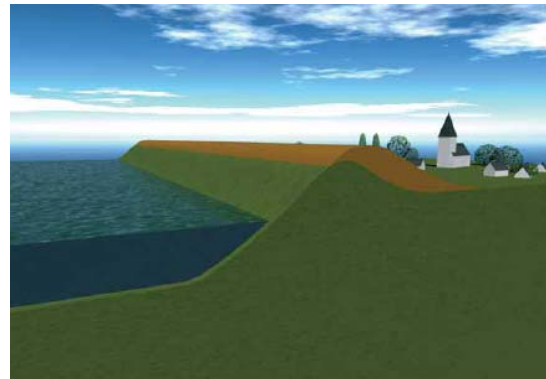
Figuur 4.1: Dijkverzwaring heeft ook landinwaarts meestal gevolgen [L.20]
