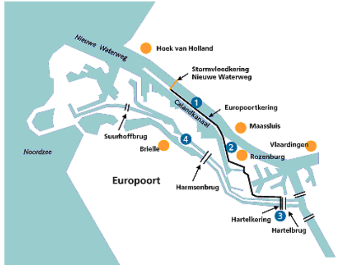
Figuur B2.5: De Maeslantkering, de Hartelkering en de Europoortkering beschermen Rotterdam [www.keringhuis.nl]
