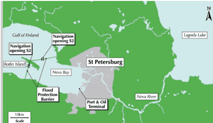
Figuur B2.18: St. Petersburg ligt in de delta van de Neva rivier. In de Neva baai wordt een kering gebouwd om de stad te beschermen tegen stormvloeden. [www.halcrow.com]
