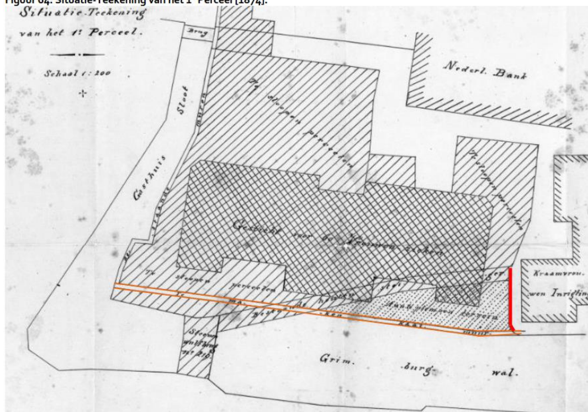
Bron: Beeldbank en Grimburgwal UVA/archieftekeningen en foto's/Sloopplan oud pand. Met lijnen van de nieuwe kade Figuur 2.2 Tracé Oude en nieuwe kade
