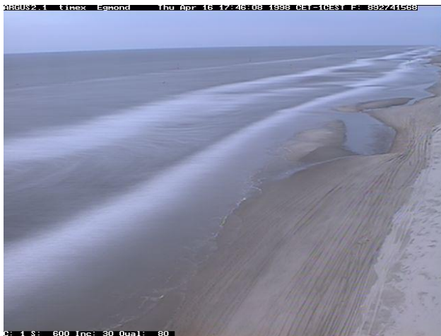
Figuur 3 Golf dissipatie in een tijdsgemiddeld video beeld (Argus). De witte banden geven de locaties aan van de banken waarop de golven breken.
