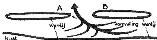
Fig. 21 Schema van aanval op de oever op het oostelijk deel van een waddeneiland.
