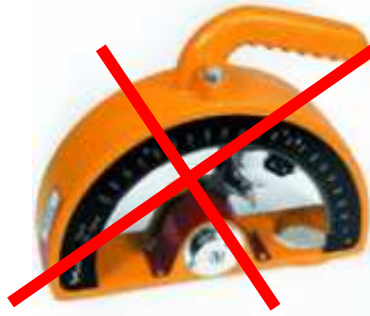
Figuur 3.8 De hardheidsmeter, nog steeds zeer ten onterechte in de restauratiepraktijk gebruikt als een maat voor kwaliteit van voegen
