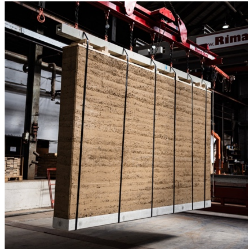
Figure 202 Prefabricated Rammed Earth Wall ( https://claytec.de/produkt/mauerwerk-stampflehm/stampflehm-fertigwand/ )
