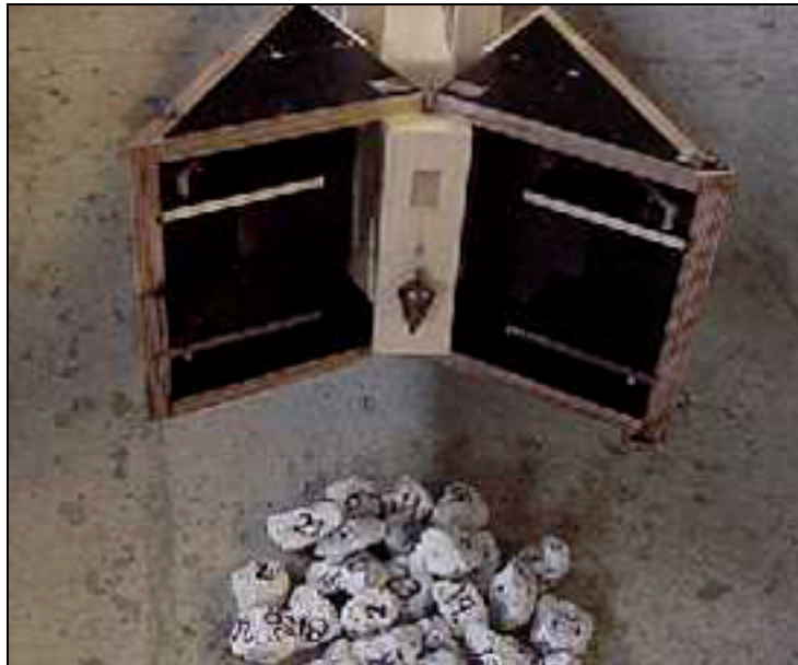
Figuur 7.2 Grijpermond met verplaatsbare schotten en peillood
