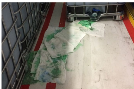
Cubitainer met een lekkende sluiting
