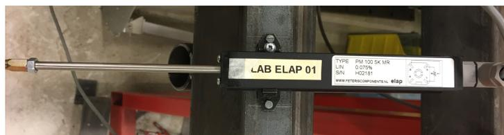
**Figure F.12:** Used linear potentiometer
