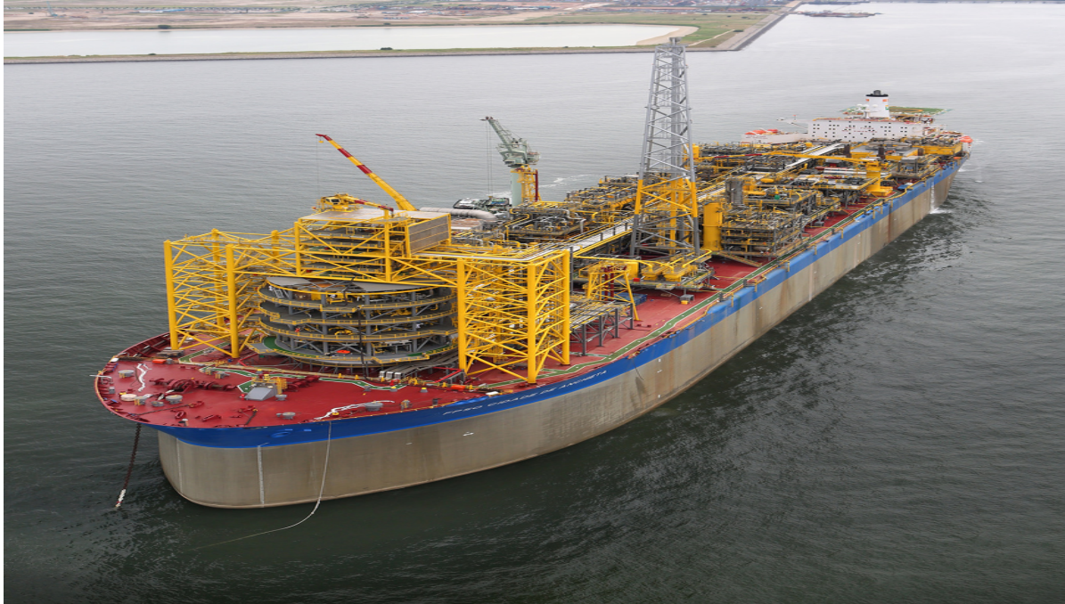
Figure 1.2: SBM Cidade de Anchieta FPSO, transformed tanker with an internal turret
