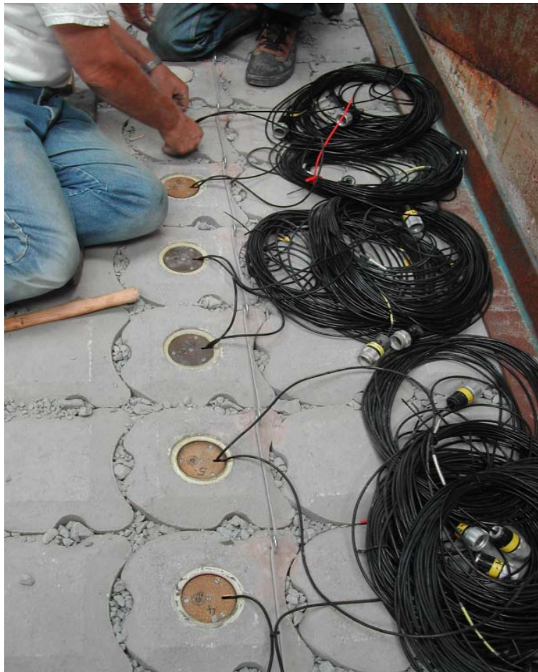
Aanbrengen van de drukopnemers
