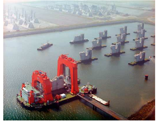
Figure 3: Ostrea 8,700mt lifting capacity (Vanhemelrijk)
