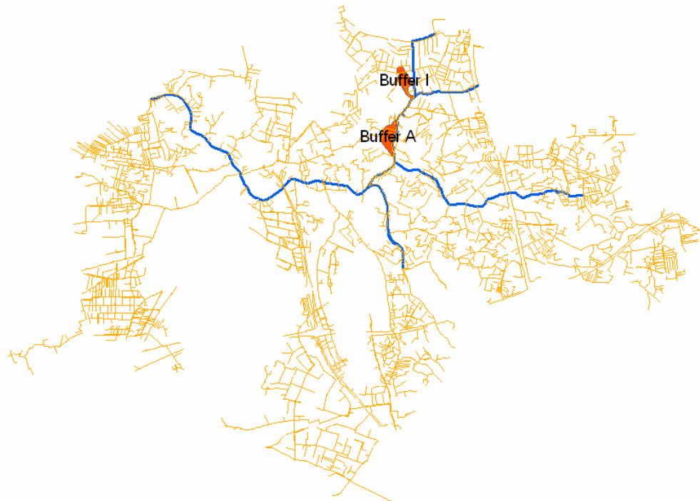
Figuur 3.4: Buffergebieden waarvan de waterhoogte en inhoud door Sobek berekend worden
