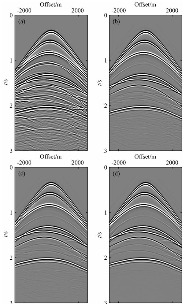
图 9 模拟波场和  $k=10, 15, 20$  所对应的消除多次波后的波场
