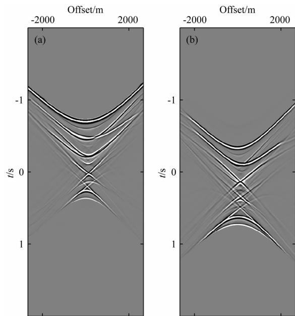
图 4 经过 20 次迭代求得的上下行聚焦函数
