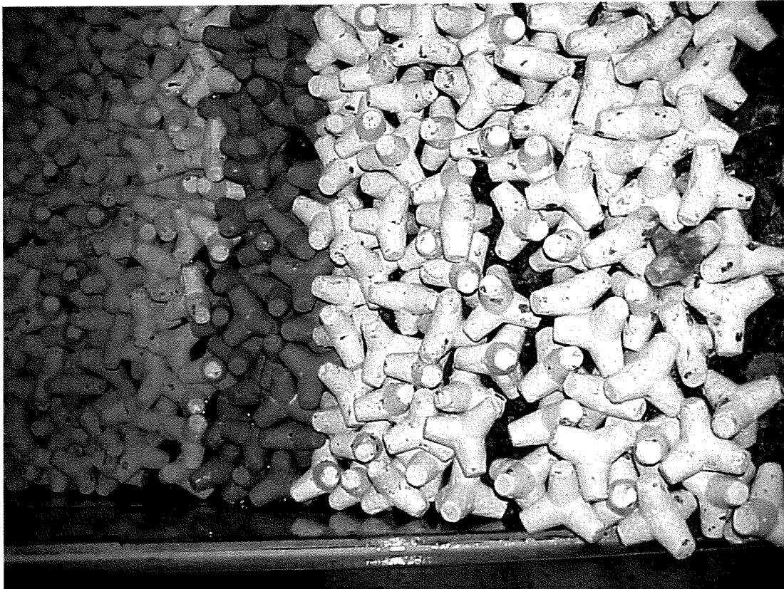
Figuur 6.5: Bezweken golfbreker met enkele 'armour layer' tetrapoden en een n_v van 0,25
