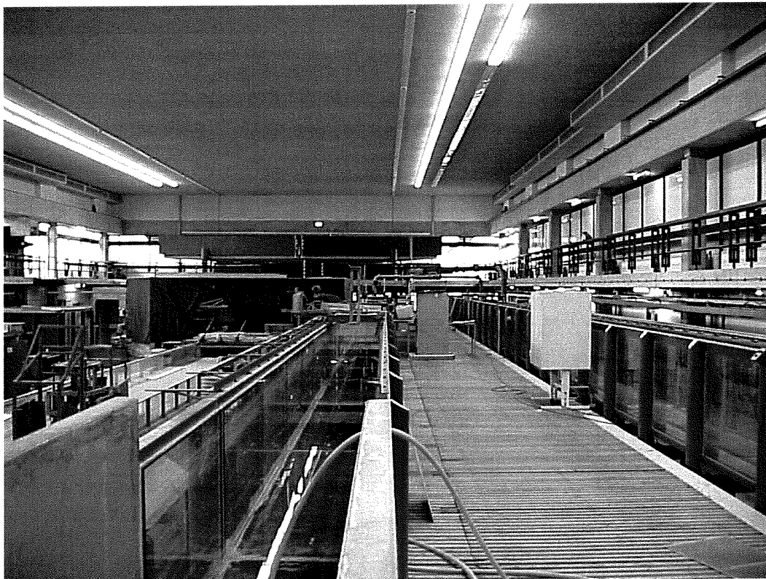
Figuur 5.1: Golfgoot Laboratorium voor Vloeistofmechanica
