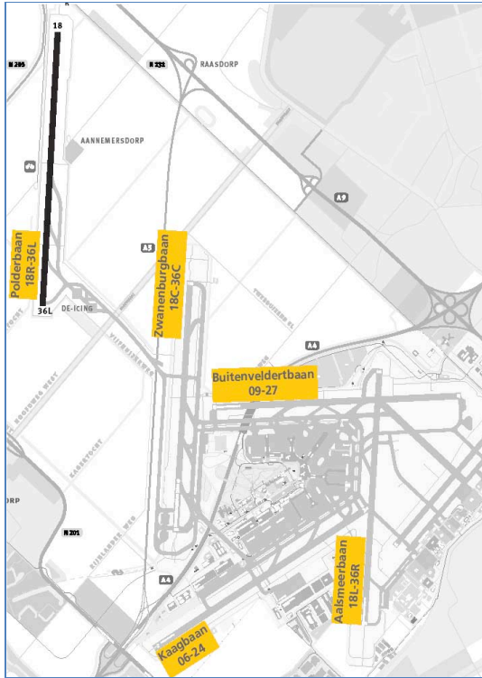
Figure 2.20; Runways of AAS ( www.luchtverkeersleiding.nl , 2012)
