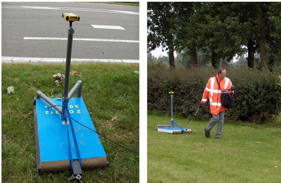
Figuur 10.1: radar en tracer, apparatuur en gebruik
