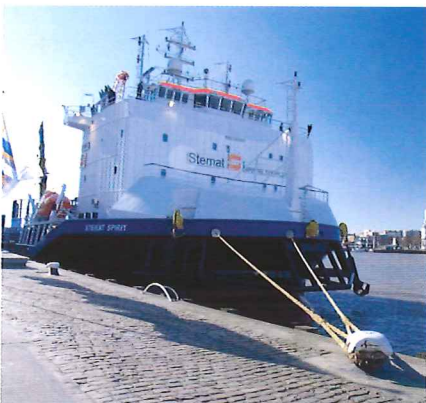
De Stemat Spirit van aannemersconcern VolkerWessels. Afbouw vond plaats bij Huisman in Schiedam. Het schip kan kabels leggen die windparken op zee verbinden met het vaste land.
