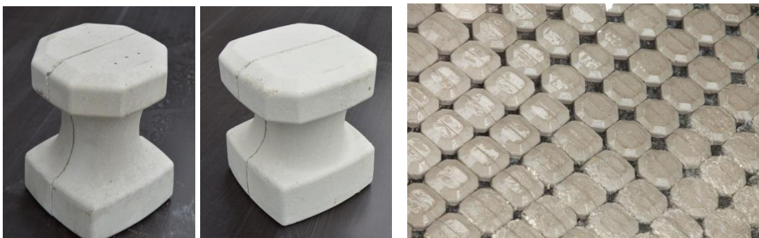
Figuur 1.2 Testblok van het type Slim (links), Testblok van het type Basis (midden), en rechts een situatie in de Deltagoot met daarin Testblok van het type Basis (links) en Testblok van het type Slim (rechts) in hun verband.
