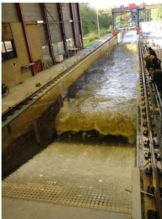
Figuur E.1 Golfaanval op testsectie van Testblokken.
