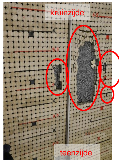
Figuur 4.3 Schade na Proef S02 ( H_s = 0,93 m, s_{op} = 0,02 ) (links: situatie direct na de test, rechts: situatie nadat de losse stenen zijn verwijderd)
