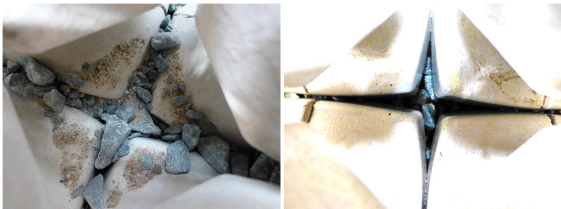
Figuur 5.2 Impressie inwasmateriaal waarbij tevens een fractie 0-4 mm is gebruikt. Links: voor de test. Rechts na een test.
