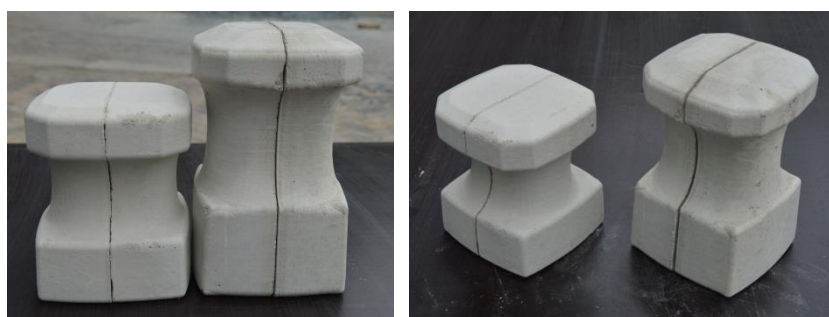
Figuur 5.4 Impressie van het verschil tussen een Hillblock met een hoogte van 20 cm en een Testblok met een hoogte van 15 cm (modelwaarden)
