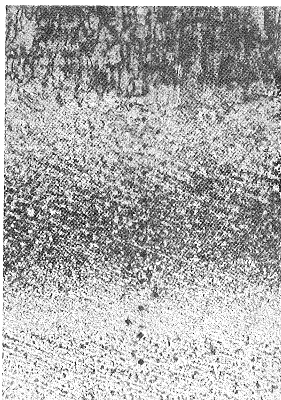
17 - b - V = 62 \times - nital HAZ in plaat; microhardheids- meting met stapgrootte 0.05 mm.
