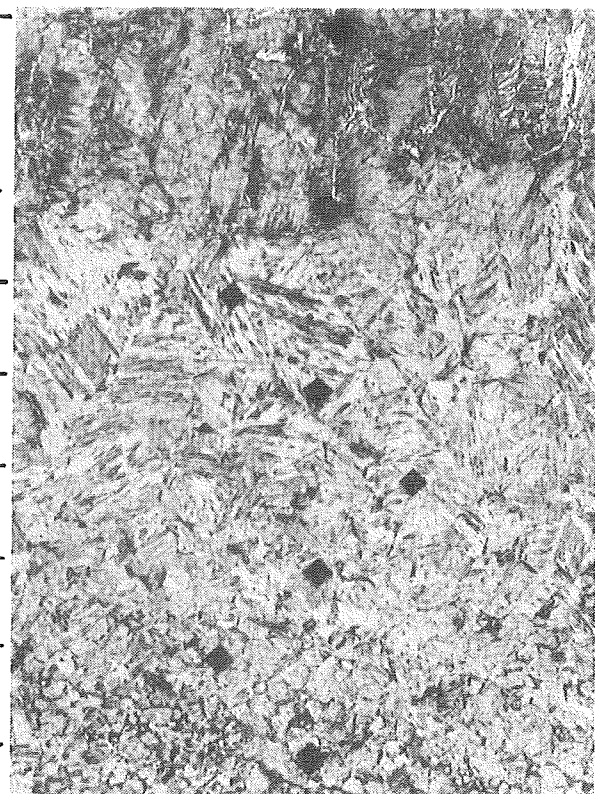
17 - c - V = 220 \times - nital Detail HAZ met grofkorrelige martensiet.
