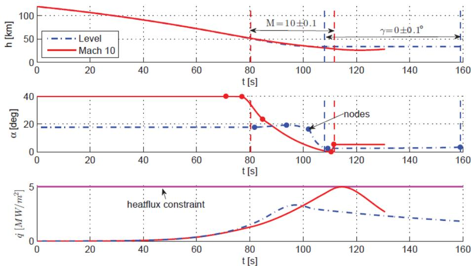
Figure 2-22: Hyperion-II optimal trajectory parameters Dijkstra et al. (2013).
