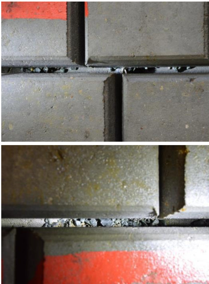
Figuur 4.6 Filtermateriaal in de spleet na proef V03 (boven) en na proef V05 (beneden)
