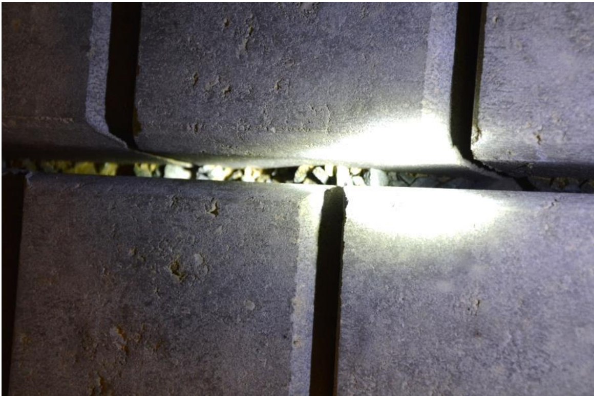
Figuur C.27 Filtermateriaal in spleet na proef V06
