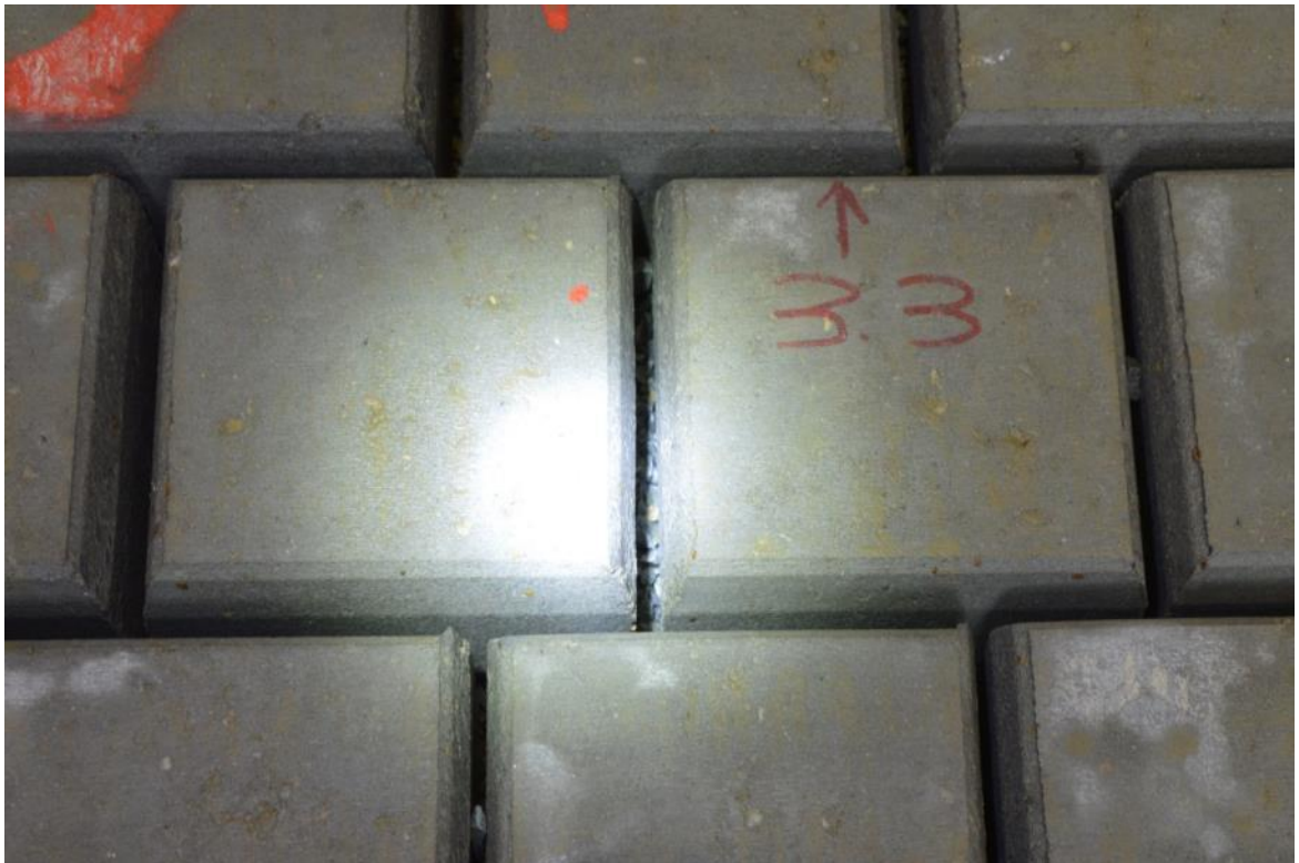
Figuur C.29 Filtermateriaal in spleet na proef V07
