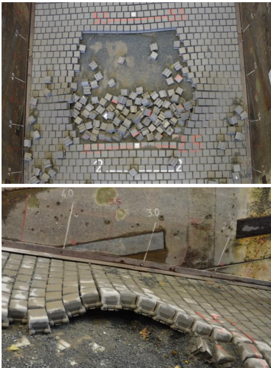
Figuur 4.12 Het gat in de bekleding na proef V10: bovenaanzicht (boven) en de rand van het gat (beneden)
