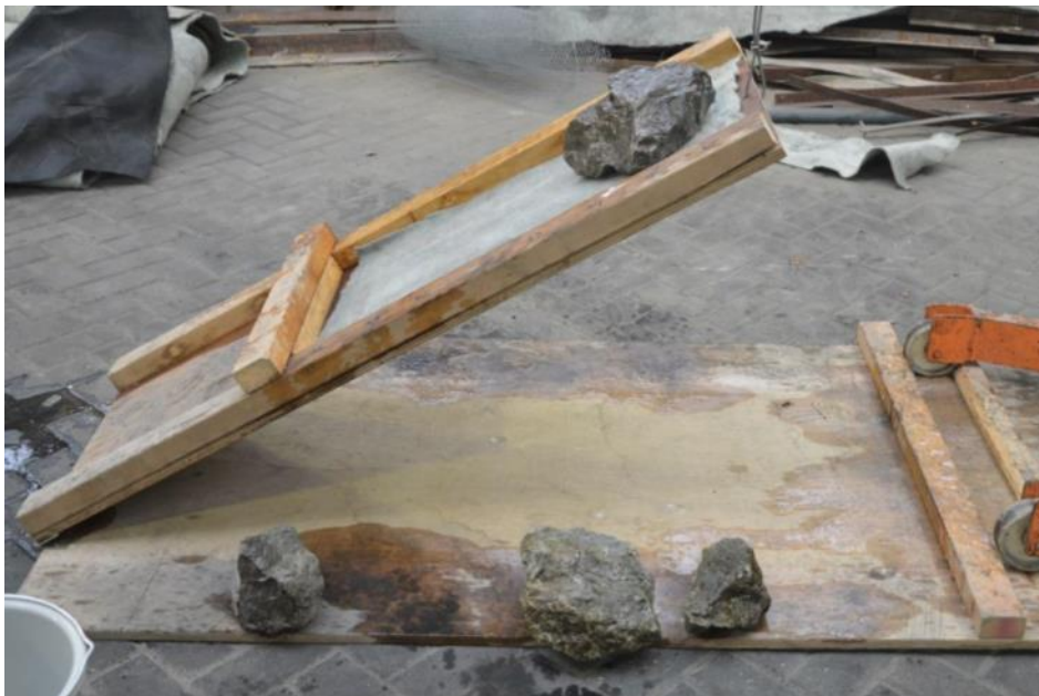
Figuur 3.2 Opstelling van de wrijvingsproeven voor het geotextiel (met de verschillende toegepaste stenen op de voorgrond)
