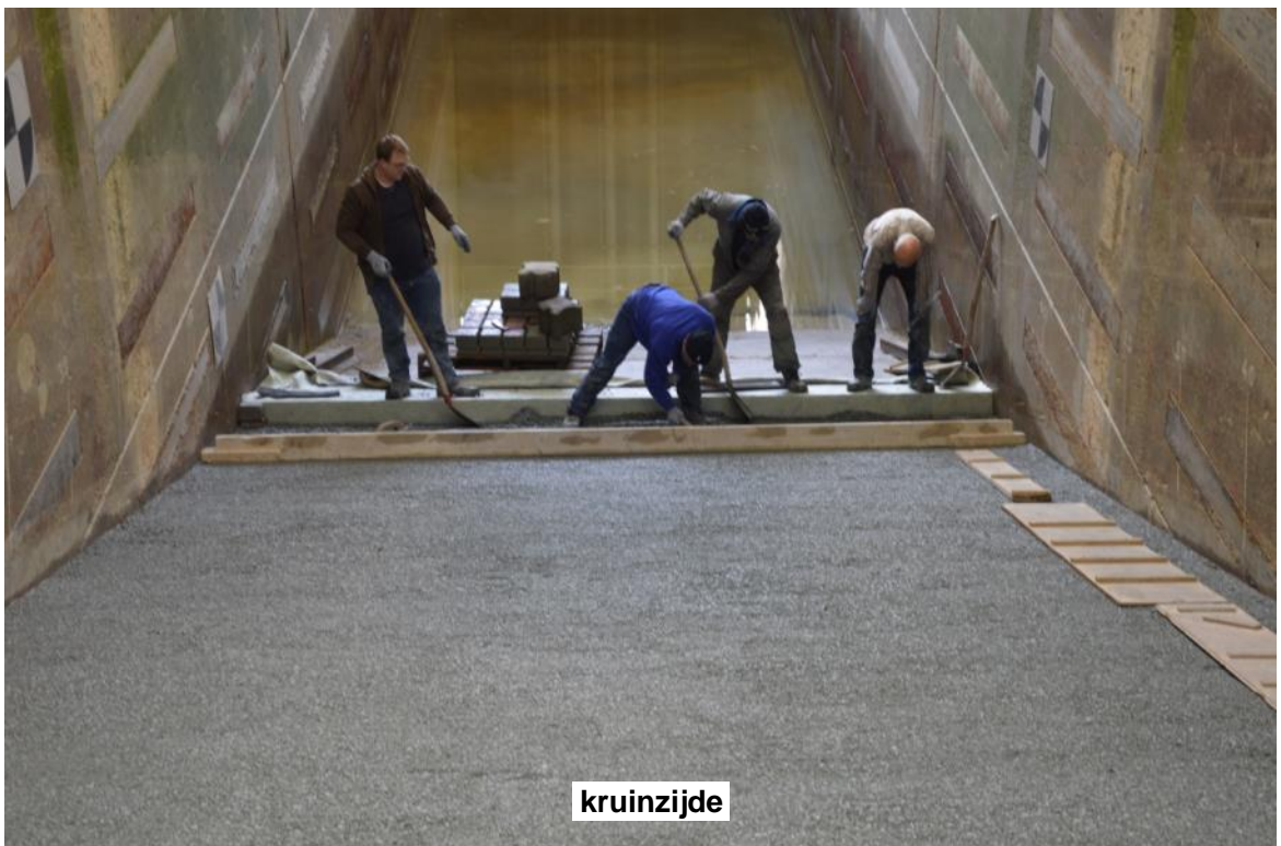
Figuur C.8 Afvlakken van het filter met behulp van een balk (voor serie 2)
