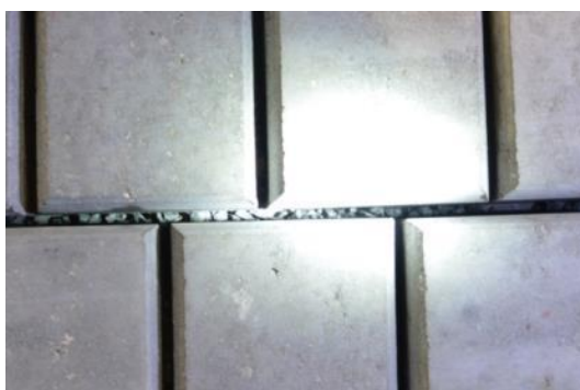
Figuur 4.15 Filtermateriaal in spleet na proef V20
