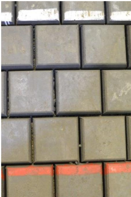
Figuur 4.9 Filtermateriaal in de spleten na proef V09
