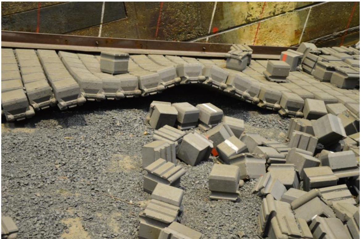
Figuur C.39 Na proef V23, rand van het gat aan de meetcabinezijde
