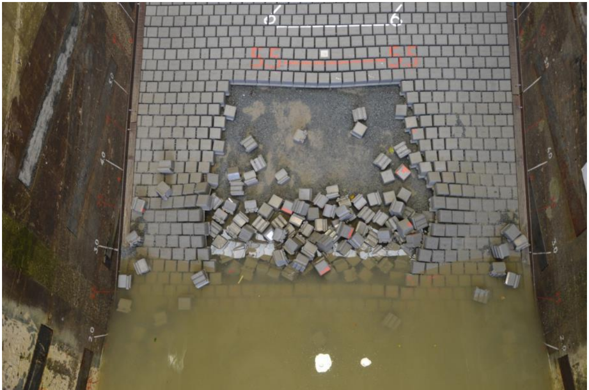
Figuur C.33 Schade na proef V10 bij dalende waterstand
