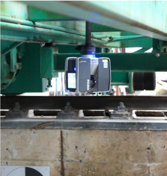
Figuur 3.9 De laserscanner hangt tijdens de meting boven het midden van de goot.
