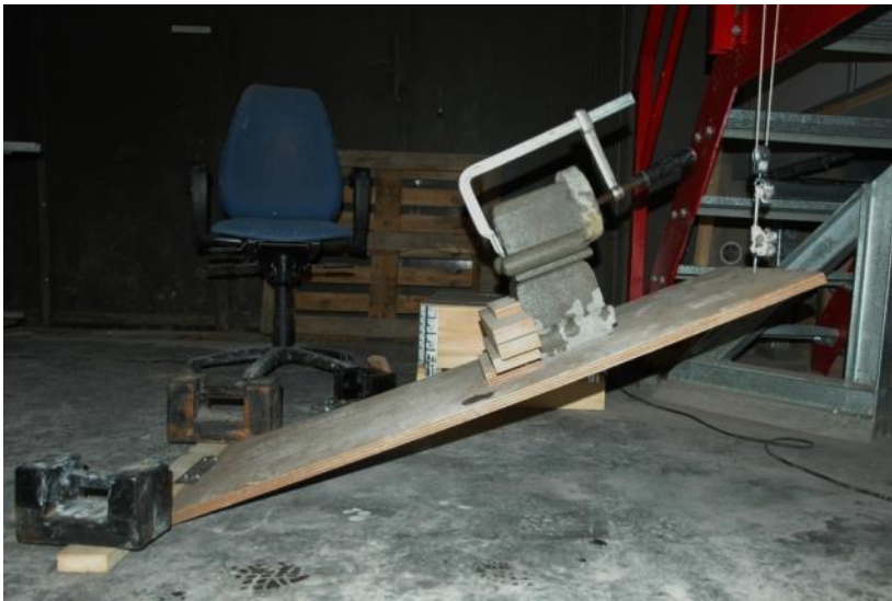
Figuur 3.5 Opstelling van de wrijvingsproeven voor Verkalit ® mgv met extra gewicht
