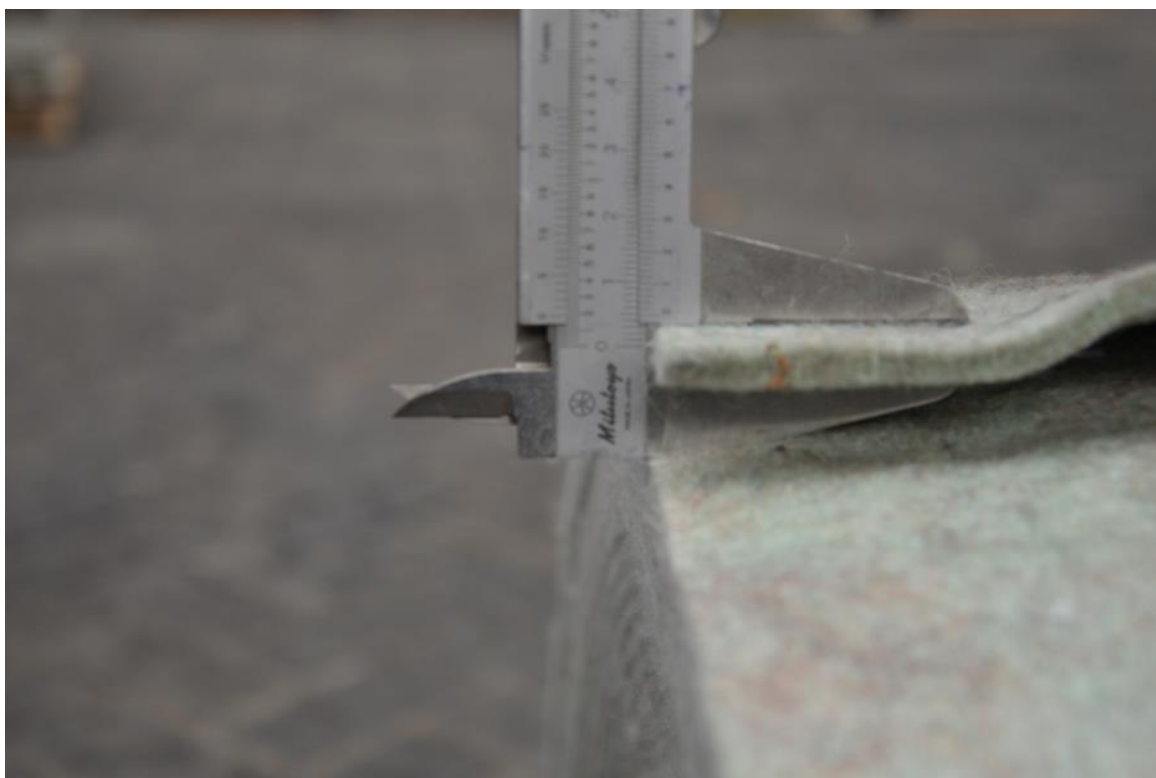
Figuur C.3 Dikte van het gebruikt geotextiel vanaf serie 2
