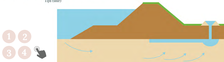
De ontwikkeling van de pipelengte tijdens een hoogwater. Gebaseerd op schema's van Joost Pol.
