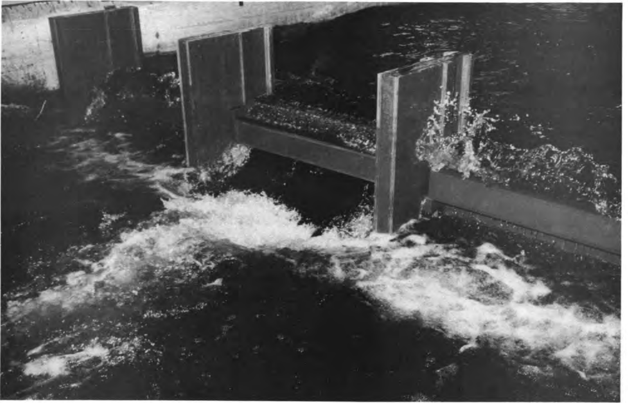
T245 Stroombeeld bij een weigerende schuif situatie; verval = 7,0 m, golfhoogte \bar{H} = 4,5 m, golfperiode T = 9,6 s
