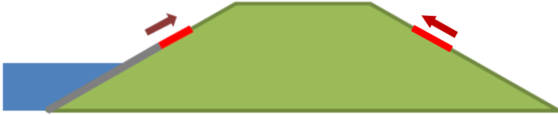
Figuur 4.1 Principeoplossing B2: Verhogen van de locatie van de overgang op het buitentalud (bron: Van Steeg en Van Hoven, 2013b)
