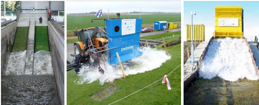
Figuur 3.1 V.l.n.r.: Indruk van Deltagoot, golfklapgenerator en golfoverslagsimulator
