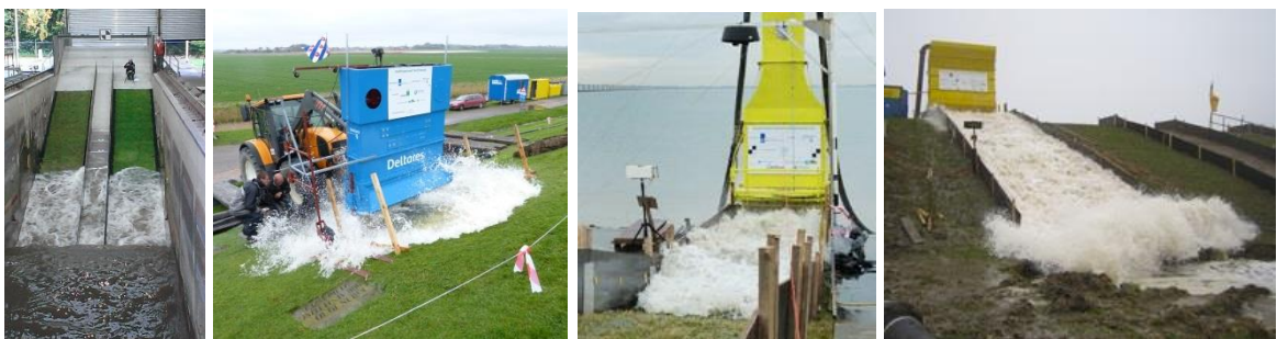
Figuur 5.1 Impressie van testen met de Deltagoot (Noordoostpolder), de golfklapgenerator, de golfoploopsimulator en de golfoverslagsimulator
