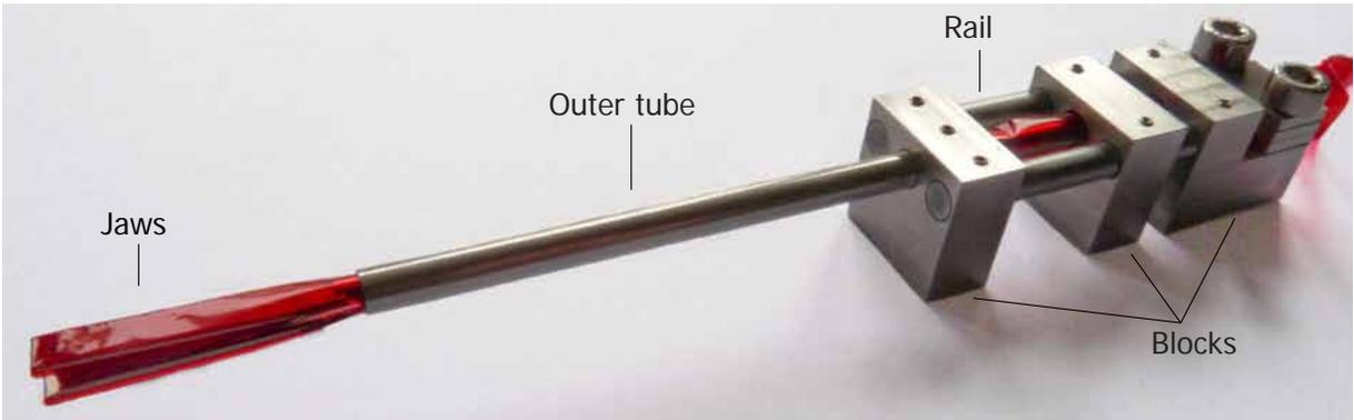
**Fig. 24:** Adhesive grasper: prototype
