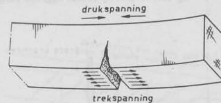
fig. 23-11 De ongewapende balk vertoont scheuren door het optreden van trekspanningen aan de onderzijde van de balk.
