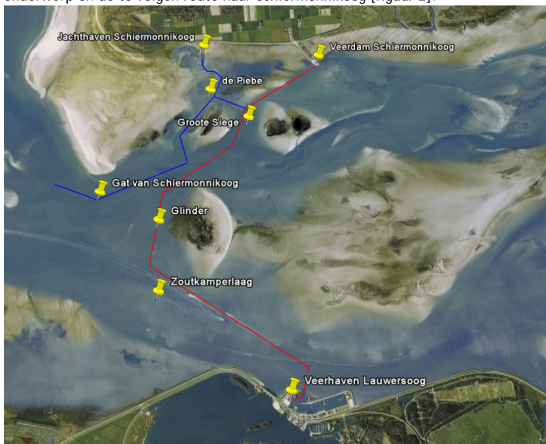
Figuur 2: De vaarroutes naar Schiermonnikoog voor de veerboot (rode lijn) en de pleziervaart (blauwe lijnen) en de belangrijkste geulen; bron Google Earth
