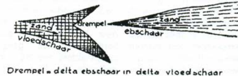
Figuur 18a: Zandtransport; vorming drempel bij aanval in de flanken door de scharen (I) (Van Veen, 1950)
