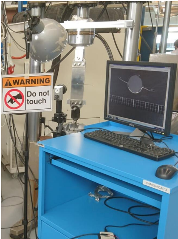
Fig. 3: Fatigue Test Setup
