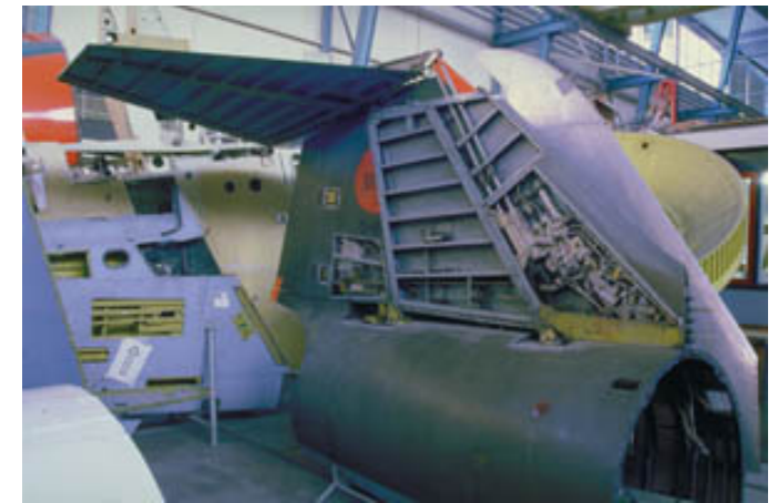
Hydraulische actuatoren van de roeren in het staartstuk van een Lockheed F-104 Starfighter.
