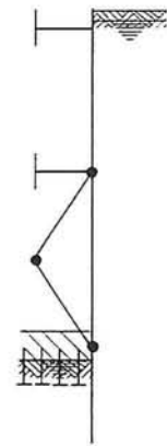
Figuur 7.1 Mechanisme met 3 vloeischarnieren
