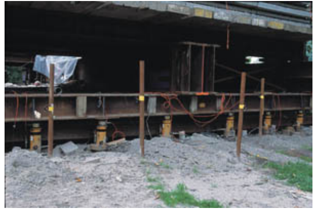
Meetopstelling van de zes houten palen. Zowel verplaatsing van de palen als de belasting werd over een periode van enkele maanden automatisch geregistreerd voor, tijdens en na het gROUTEN.
