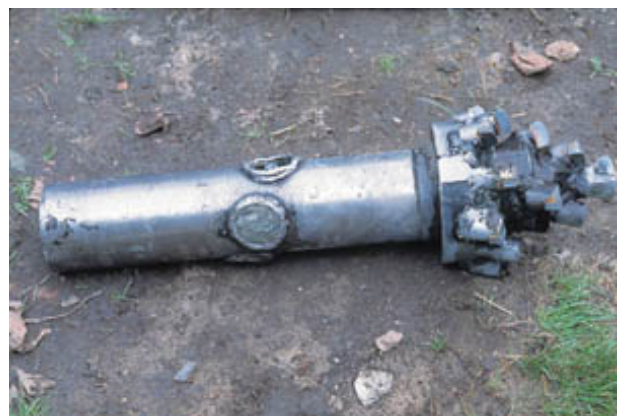
Detail van de grout-installatie, waarop de lans en de retourspoeling (spoil) zichtbaar zijn.
