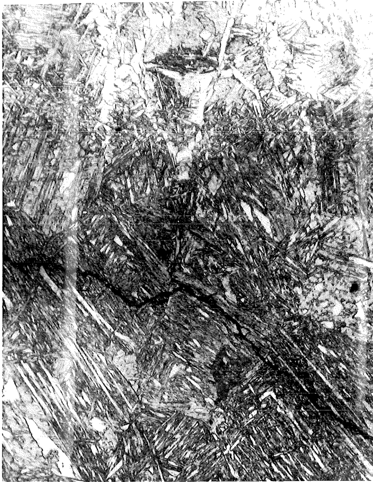
Fig.65: Een waterstofscheur in de warmte invloeds zone van St52.
