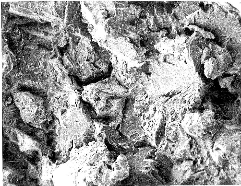
Fig.67: Het interkristallijn breukoppervlak in de warmte invloeds zone. (vergroting 200 x )
