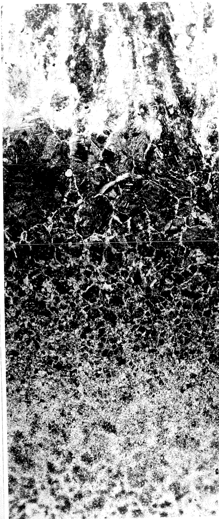
Fig.63: Een opname van de W.I.Z. van St42.
