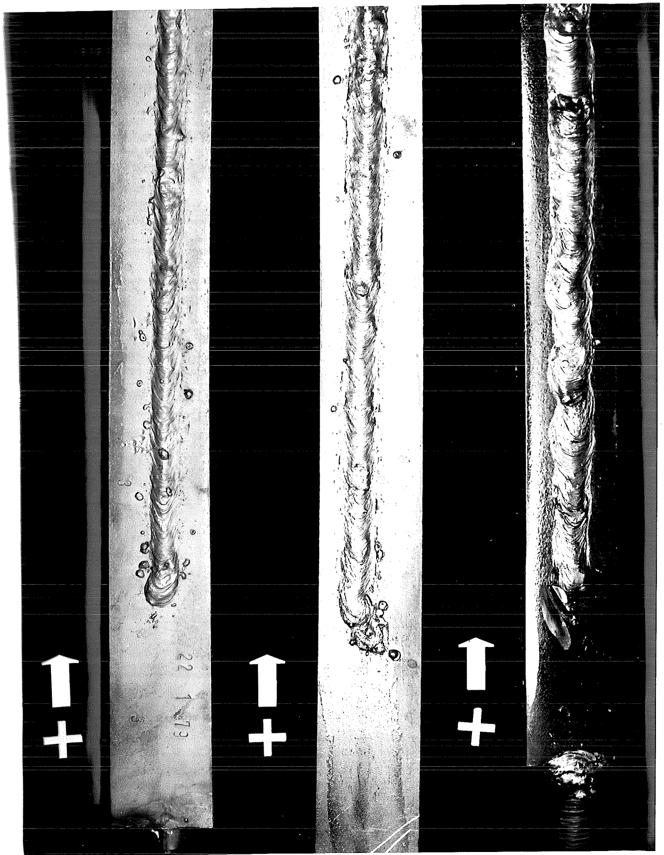
Fig.27: Het lasuiterlijk wanneer van de aansluitklem af wordt gelast. (+ is de positie van de aansluitklem.)
