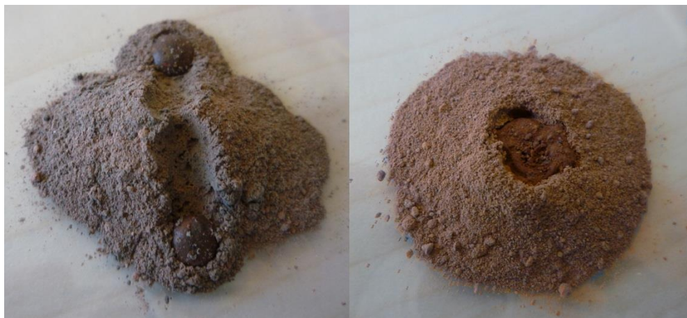
Fig. 9. Monsters met (links) en zonder (rechts) duidelijk waterafstotende eigenschappen.
