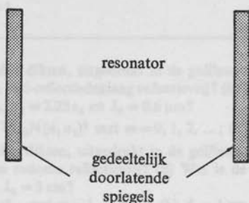
Fig. 52. FABRY-PEROT resonator, bestaande uit twee onderling evenwijdige, goed reflecterende, vlakke spiegels.
