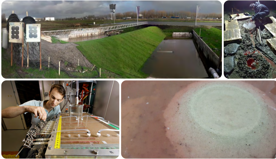
Piping-experimenten. Linksboven: proef op grote schaal in de Flood Proof Holland proefpolder bij de TU Delft. Rechtsboven: metingen tijdens de proef op grote schaal. Rechtsonder: zandmeevoerende wel in de proef op grote schaal. Linksonder: experimenten op kleine schaal. Foto © Sam Rentmeester.
