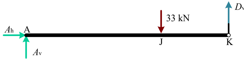
Fig. 204 Foutief vrijlichaamsschema van AK waarbij de pendelstaaf OG wordt genegeerd. Nu kunnen direct oplegreacties/inwendige krachten worden berekend
