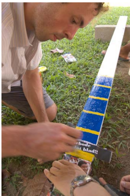
Figuur 7 Het verven van de peillatten
