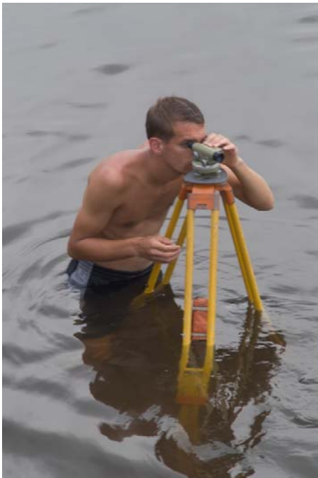
Figuur 10 Verhang meten met waterpasinstrument
