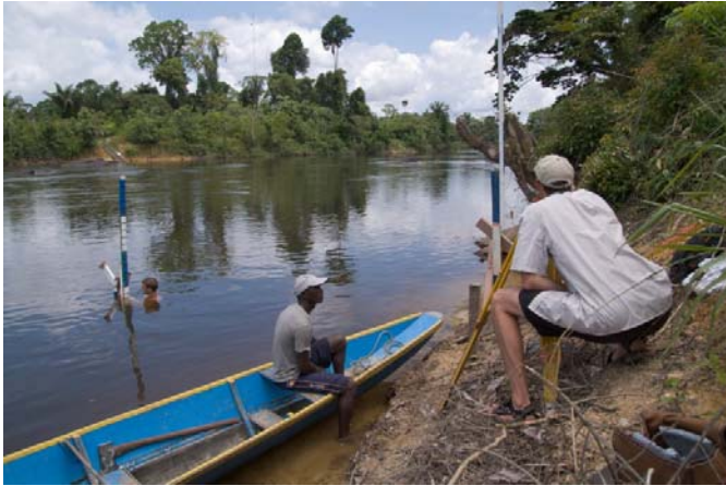
Figuur 8 Op gelijke hoogte brengen van de peillatten
