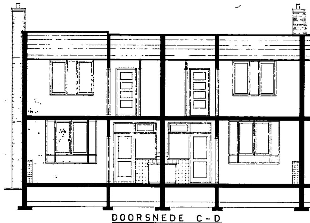
Figure 5.14, raft foundation of buildings in the Goudenregenlaan. Source: Archive of Woningbeheer Gemeente Delft, drawingnumber: 29322 (Plattegronden en doorsneden Bomenwijk).
