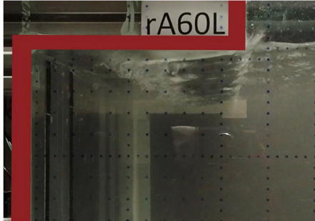
(d) Impact Type IV: for AL and CL. Extensive entrapped air, distributed
