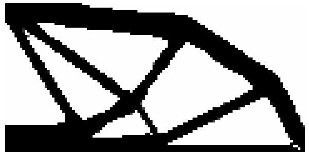
(d) Best design after post-processing, filtered C \approx 91.11
