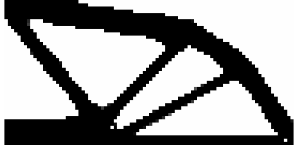
(d) Best design after post-processing, filtered C \approx 91.87
