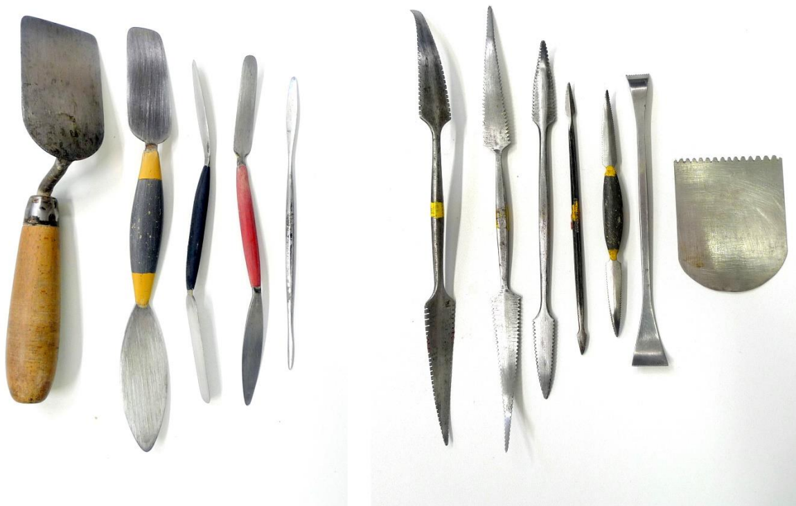
Fig. 1: Gereedschap voor aanbrengen en afwerken van restauratie mortels. Links: kleine troffel en paleerijzers van staal in verschillende maten. Rechts: getande, iets gebogen, gipsijzers om de vormen in te snijden
