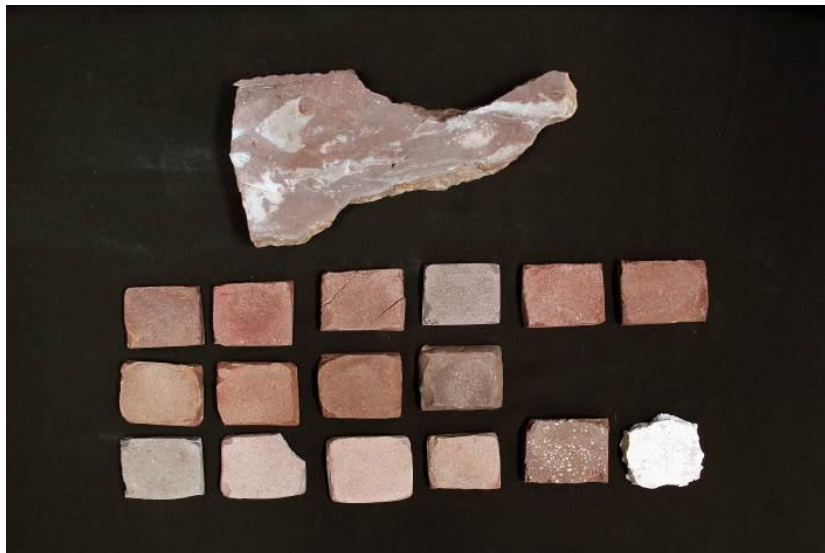
Fig. 7: Met pigment aangekleurde zinkoxidemortelstalen
