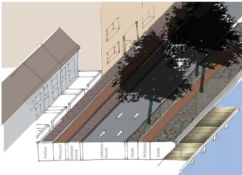
Figuur 11.22. Profiel Spaarne-oever nieuw
