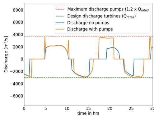
(d) Discharge through pump/turbines at 0.3 meter sea level rise
