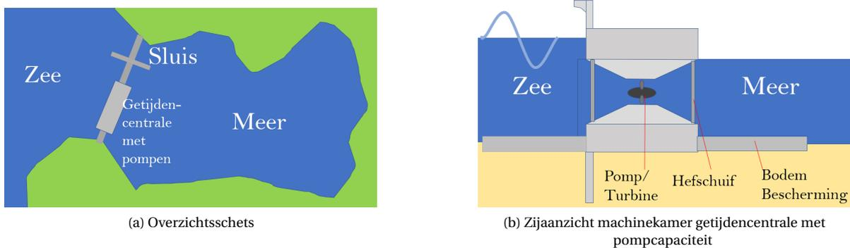
Figure 3: Getijdencentrale met pompcapaciteit
