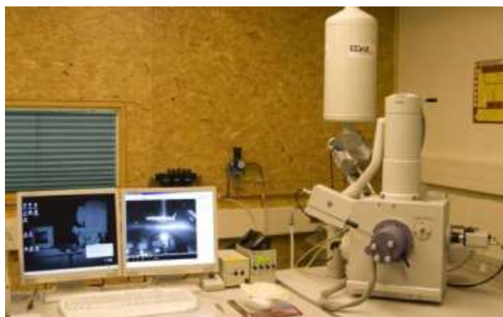
Fig. 3-4 Philips XL30 ESEM electron microscope
