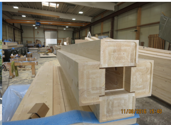
Figure 9. Prefabricated timber columns (Wächter + Wächter Architekten, 2019)
