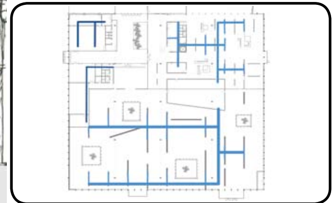
Toe- en afvoer ventilatie via vloer
