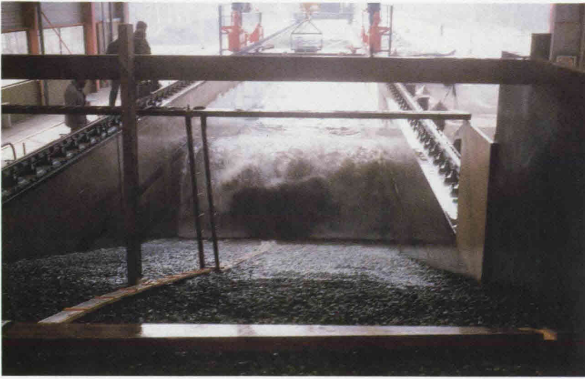
Figuur 7: Golfbelasting op open steenafalt in de Deltagoot
